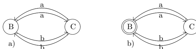
Рис. 10.1: а) Простой конечный автомат и б) Тот же автомат с выделенным принимающим состоянием
