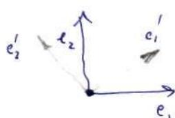
$$R_\varphi = \begin{pmatrix} \cos \varphi & -\sin \varphi \\ \sin \varphi & \cos \varphi \end{pmatrix}$$
